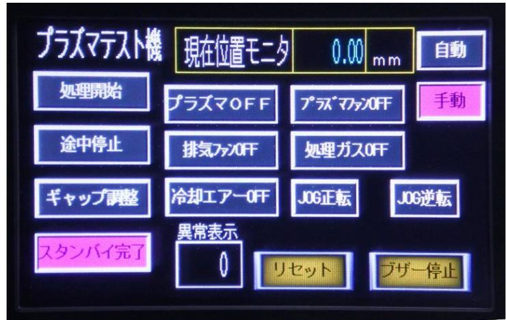
「処理開始」 …可動試料台が奥まで移動します
