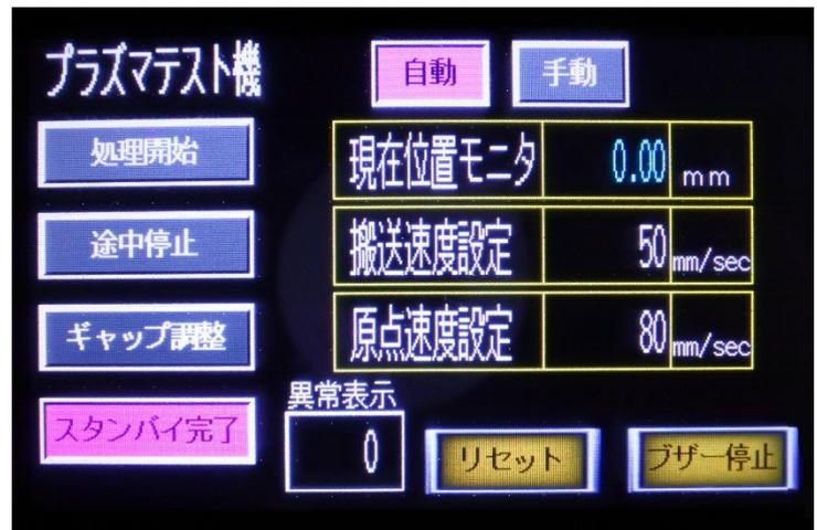
「処理開始」 …プラズマ処理を開始します。処理終了後スタンバイ位置に戻ります
