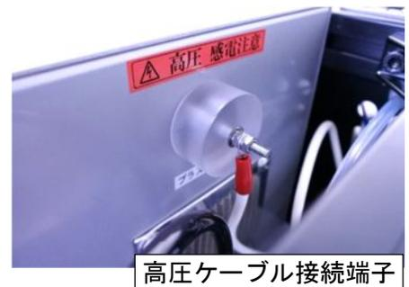
ジェット型は装置背面の接続端子台にアースケーブルがつながっています。ドライバーで外し、ケーブルを抜き取ってください。
